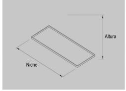
1. Fazer a furação do nicho para embutir a luminária de acordo com as descrições dos modelos. Observar também que a altura interna do gesso em relação ao teto deverá ser superior a 15cm (altura da peça).
